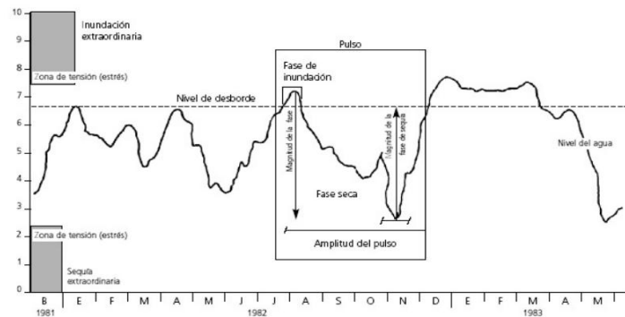
Figura 1 Representación grafica de la secuencia de pulsos. tomado de Neiff et al (1994).
