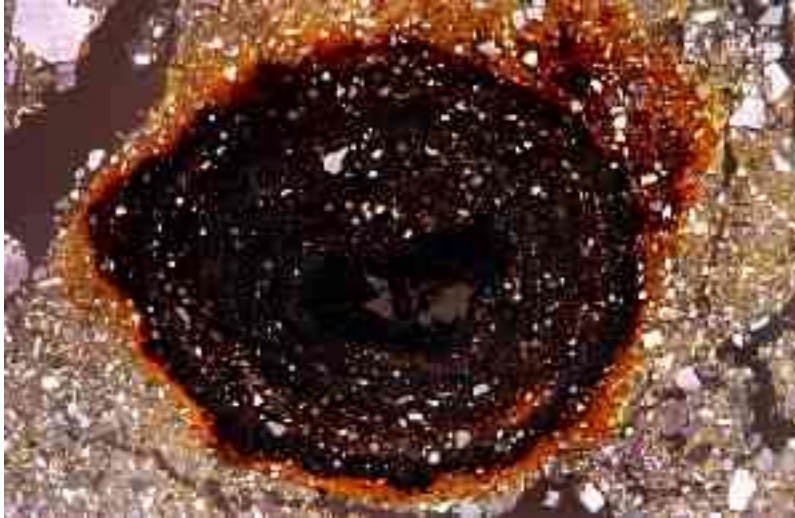
Figura 6. Microfotografía del corte de una concreción; nótese la definición abrupta del límite, respecto a la matriz del suelo.
