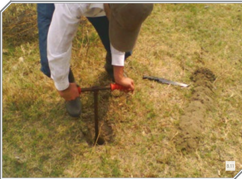
Figura 8.11. Elaboración del barrenaje. Ejemplo de cómo se dispone el material barrenado (observación de comprobación). Foto: Oscar Acevedo (2014).
