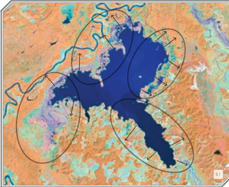
Figura 9.1. Ciénaga del Opón (Simacota, Santander). Identificación de los diferentes sectores del humedal (elipses negras) y el trazo ideal y la disposición sugerida de los transectos para evaluar la transición de la condición hidrófila hasta la terrestre en cada uno de los sectores identificados (flechas negras). Imagen Landsat 8 (04 ene 2015, combinación 5, 6, 2; 1:50.000). Cortesía de USGS.
