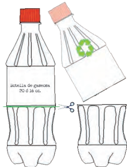
Figura 8. Construcción de un embudo por medio de botellas plásticas
