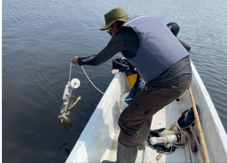
Figura 3. Toma de muestra de comunidades planctónicas con botella de Van Dorn.
