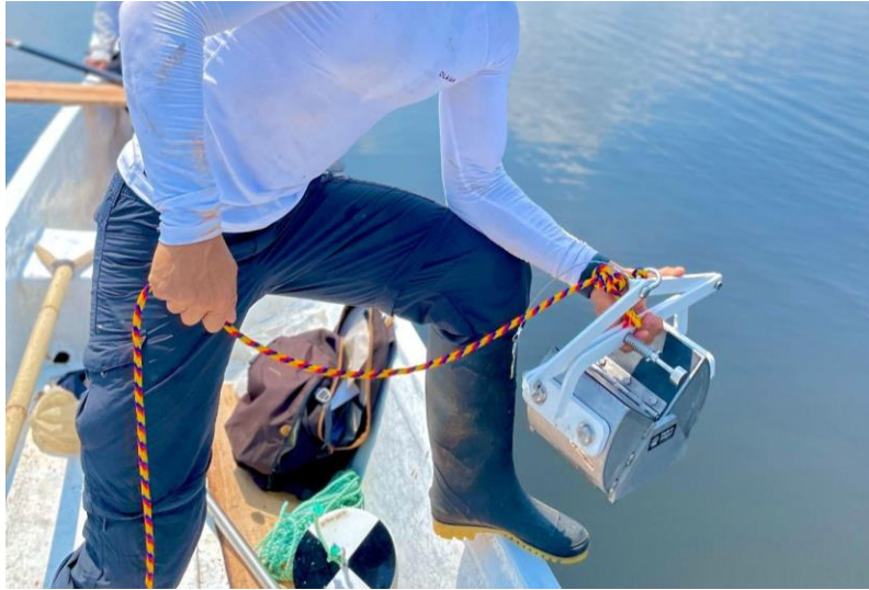
Figura 6. Toma de muestra de la comunidad bentónica por medio de la draga.
