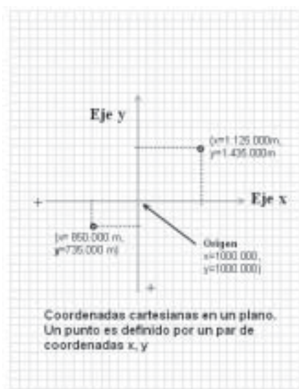
Figura 3.4.5 Sistema de coordenadas planas o cartesianas
