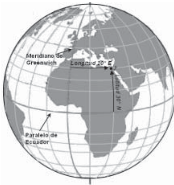
Figura 3.4.2 Medición de la latitud y la longitud
